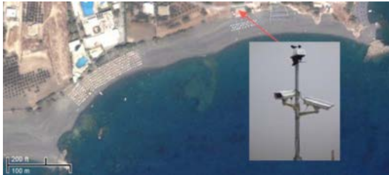
Σχήμα 1: Χάρτης θέσης της περιοχής μελέτης με ένθετη φωτογραφία του συστήματος οπτικής παρακολούθησης και του μετεωρολογικού σταθμού (Πηγή δορυφορικής εικόνας: Google Earth)
